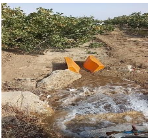
شکل ۶- اندازه‌گیری آب باغ‌های پسته با فلوم WSC
